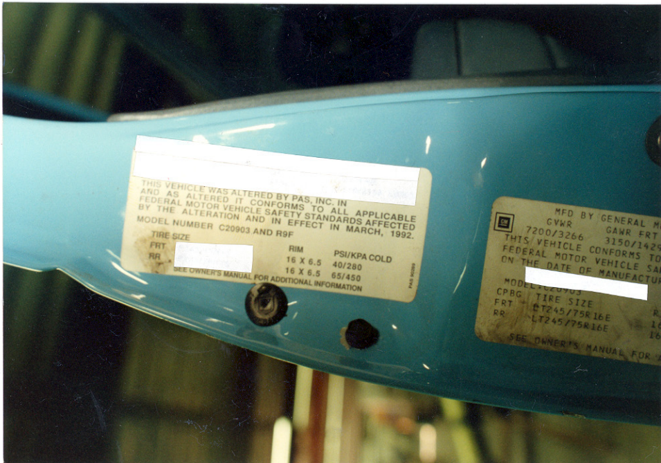
36. PAS Label on Inside Surface of Left Door
